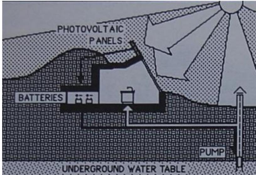
En este caso, el pozo puede bombearse con energía eléctrica acumulada por el sistema de energía de la NaveTierra, que puede ser generada a través del sol o el viento. Los sistemas de energía solar son el resultado de paneles fotovoltaicos ubicados en la cara sur de la nave. Los dispositivos eólicos pueden incorporarse a la estructura en áreas donde el viento sea una fuente confiable de energía.
